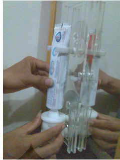
Gambar III.20 : cara memasang pasta gigi pada toothpaste dispenser
