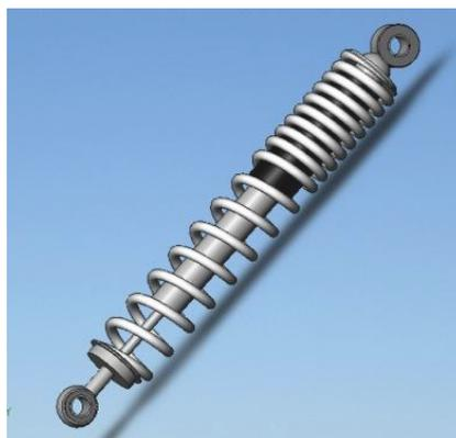
Gambar 4.13. Pemodelan *shock absorber*
