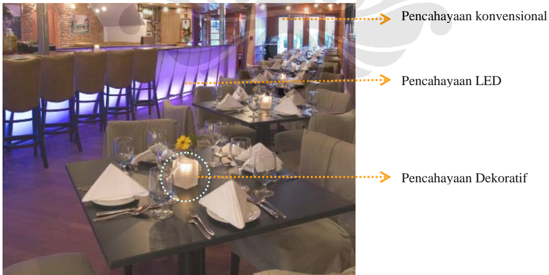
Gambar IV.2. Sistem Pencahayaan pada 33 Restoran & Lounge. ( www.33restaurant.com )
