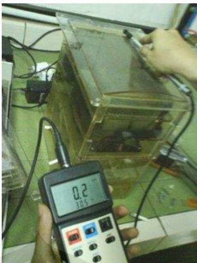
**Gambar 3.15** Pengukuran kecepatan aliran udara
