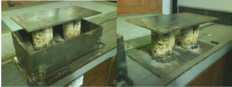
**Gambar 3.10** Cetakan besi untuk karbon aktif
