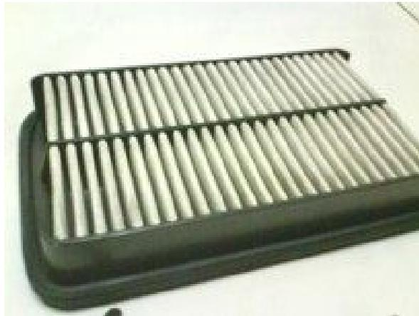
**Gambar 3.4** Filter udara Toyota Avanza
