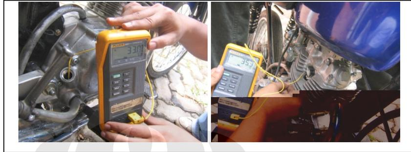
**Gambar 3.8.** Pengukuran temperatur oli dan temperatur busi
