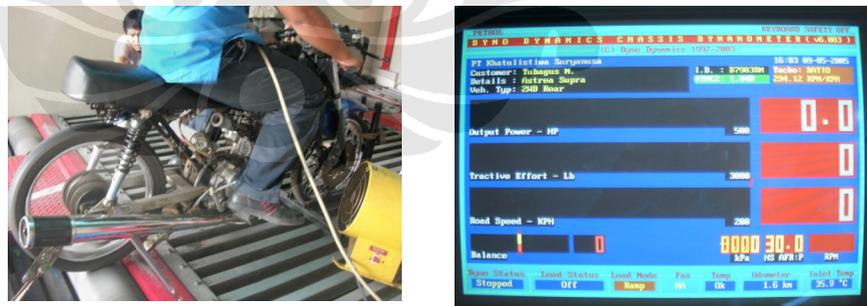
**Gambar 3.11** proses pengambilan data dengan Dynamometer
