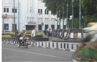
*Gambar 3-28. Zona buffer didekat perempatan jalan yang dibatasi oleh bollard sehingga pedestrian bebas menyeberang dititik yang mereka sukai. (sumber : dok pribadi)*
