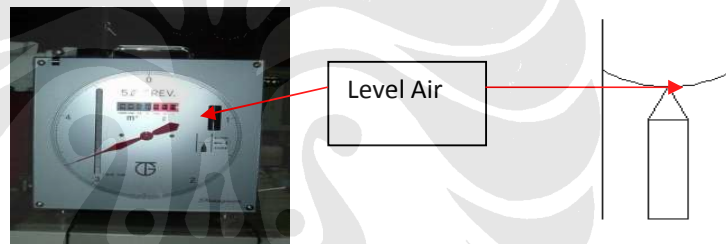
Gambar 3. 5 Level air pada Wet Gas Meter
