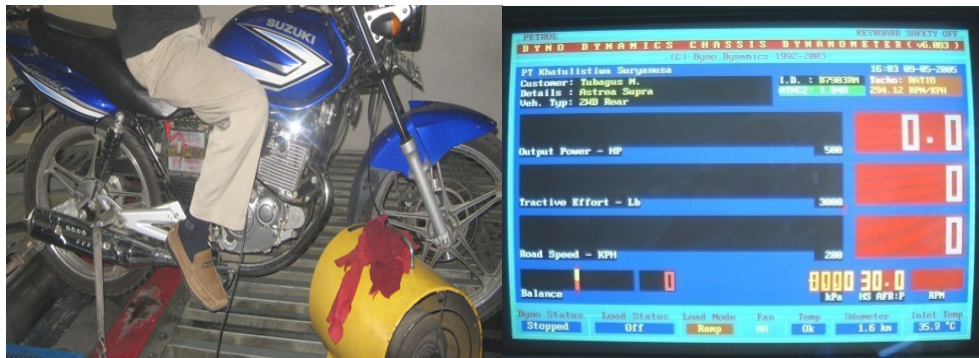
Gambar 3.7 proses pengambilan data dengan Dynamometer
