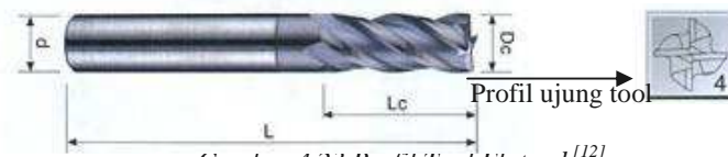
Gambar 4.23 Profil Tool Flatend [12]
