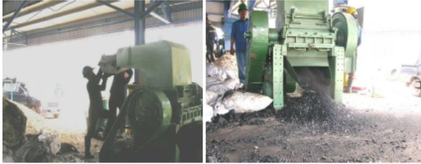
Gambar 26. Alat potong (*Crusher*)
