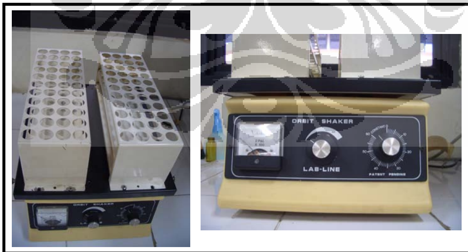
Gambar 21. Orbit shaker yang digunakan untuk fermentasi tahap I.
