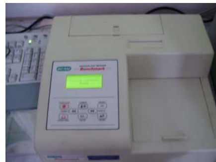
Microplate Reader digunakan untuk pembacaan hasil MTT assay
