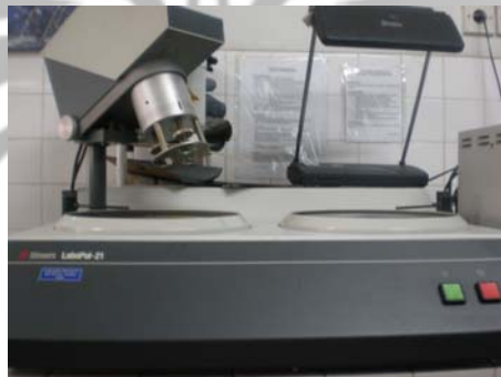
Alat pengasah spesimen (Struers Labopol-21)
