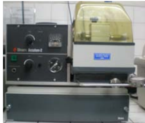
Alat pemotong spesimen (Struers Accutom-2)
