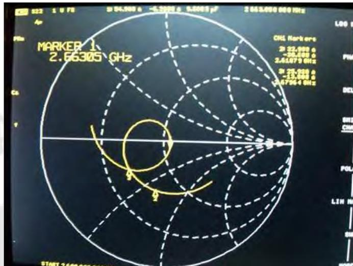
Gambar 4. 9. Plot impedansi masukan untuk antenna DGS
