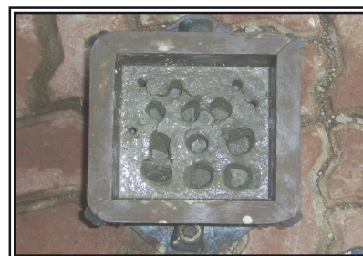
Gambar 5.5 Alat Setting Time dan Benda Uji
