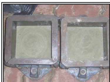
Gambar 5.5 Alat Setting Time dan Benda Uji
