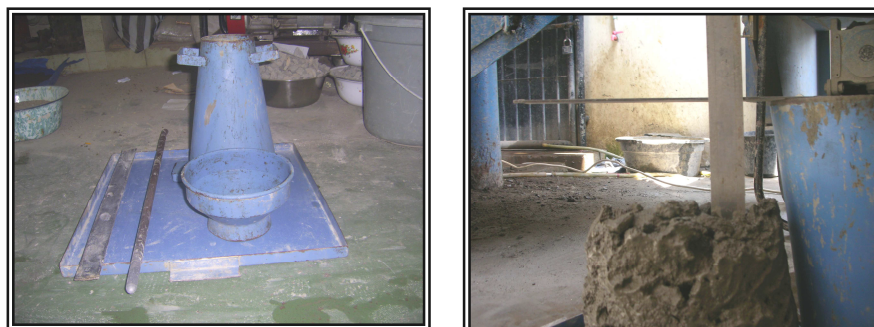
Gambar 5.2 Alat Slump Test dan Pengujian Slump
