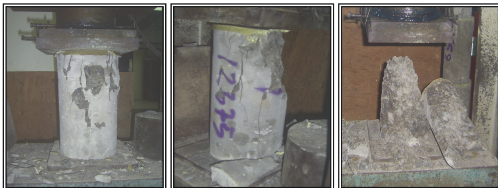
Gambar 3.6 Proses dan Hasil Pengujian Kuat Tekan
