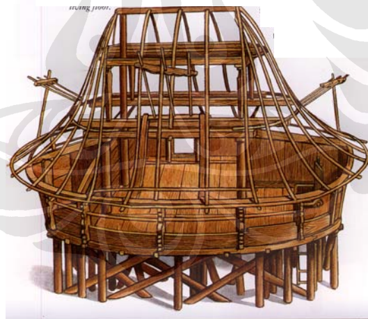
Gambar 4.29 Sistem Struktur Rumah Tradisional Nias Utara
