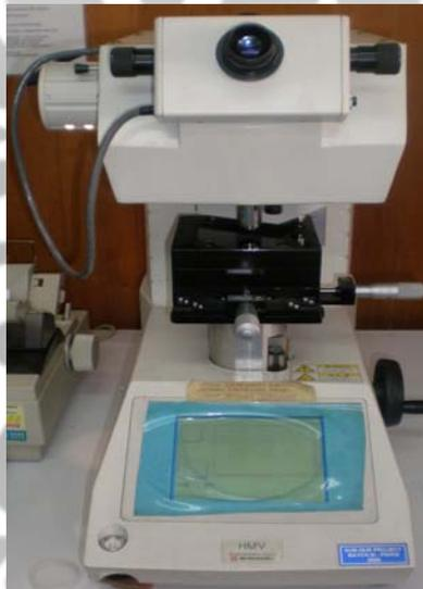
Gambar 2.10 : Alat uji kekerasan permukaan (Vicker)
