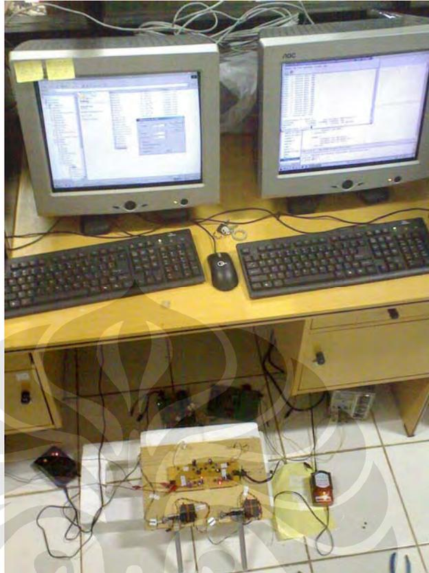
Gambar 3.5. Rangkaian hasil perancangan perangkat keras untuk pengendalian bilateral robot
