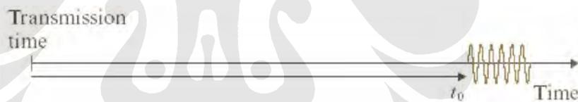
Gambar 2.2 Waktu transmisi sonar
