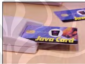
Gambar 2.7. Gambar smart card dan reader
