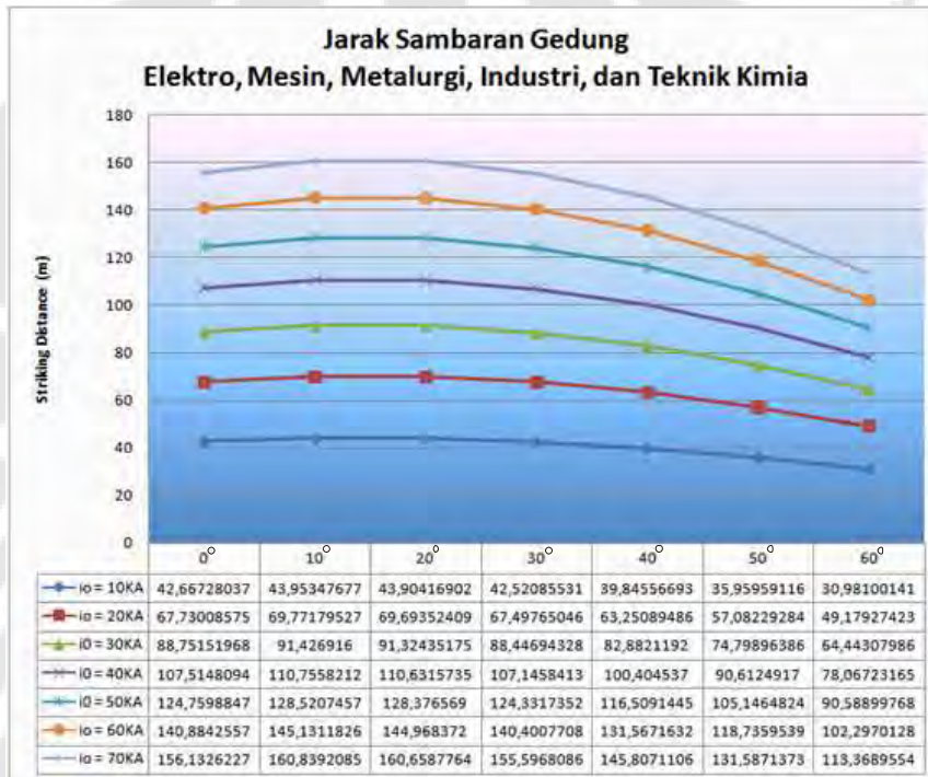
Gambar 4.1 jarak sambaran vs sudut datang petir di gedung elektro, mesin, metalurgi, industri dan teknik kimia.
