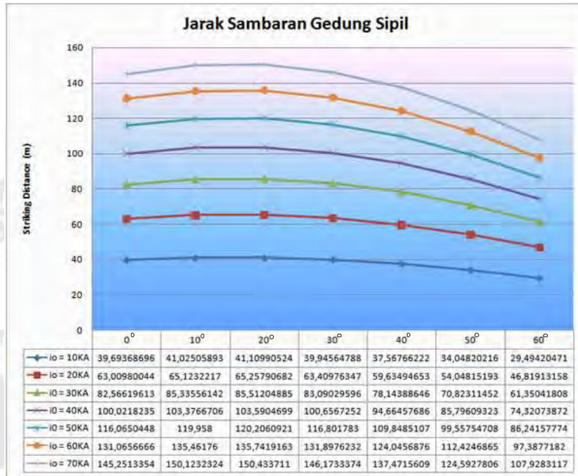
Gambar 4.4 jarak sambaran vs sudut datang petir di gedung teknik sipil
