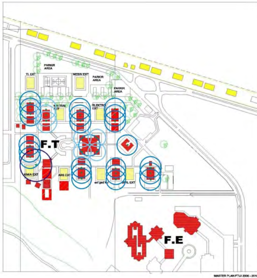
Gambar 4.20 Area proteksi gedung-gedung di FTUI
