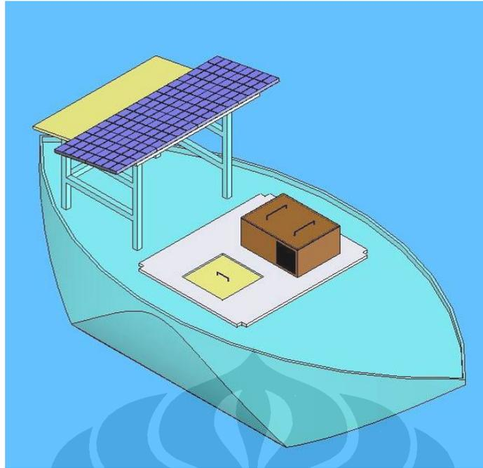
**Gambar 3.12** Rancangan instalasi *solar cold storage* pada kapal nelayan
