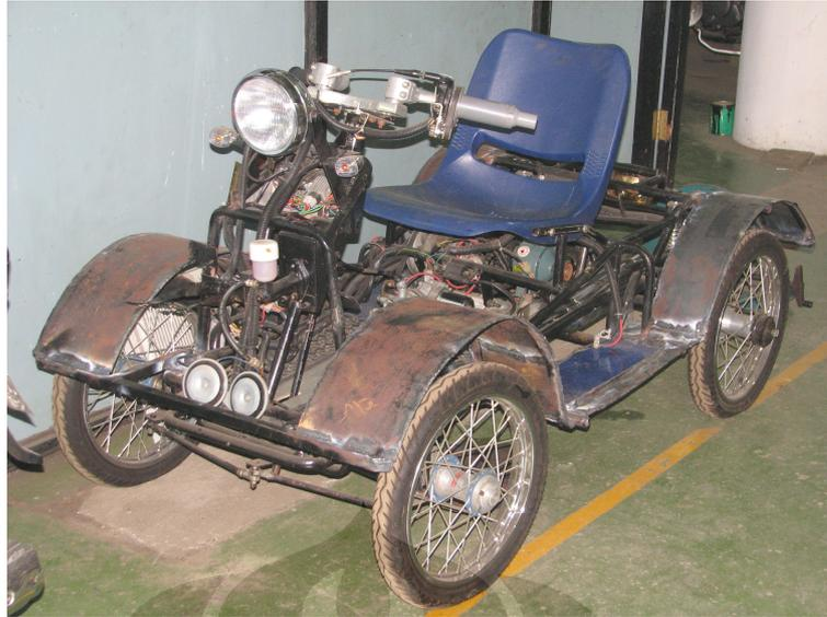
Gambar II. 2 : Kendaraan Hybrid Hasil Riset DTM-FTUI
