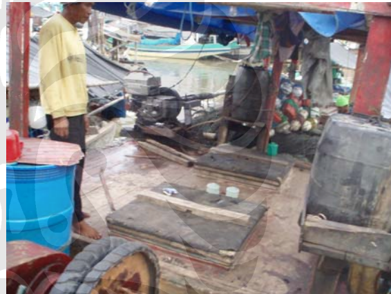
Gambar L. 4 Palka dengan kapasitas 120 kg ikan dalam kondisi tertutup
