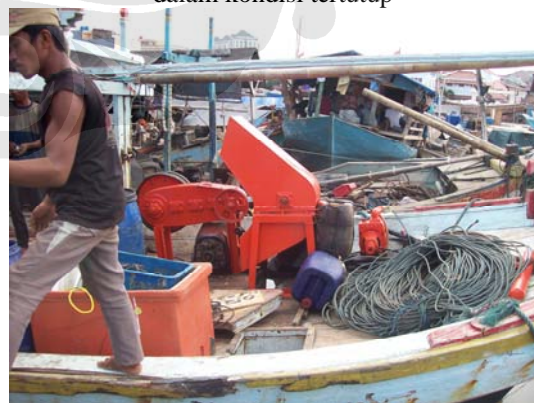
Gambar L. 6 Mesin penghancur es di kapal nelayan
