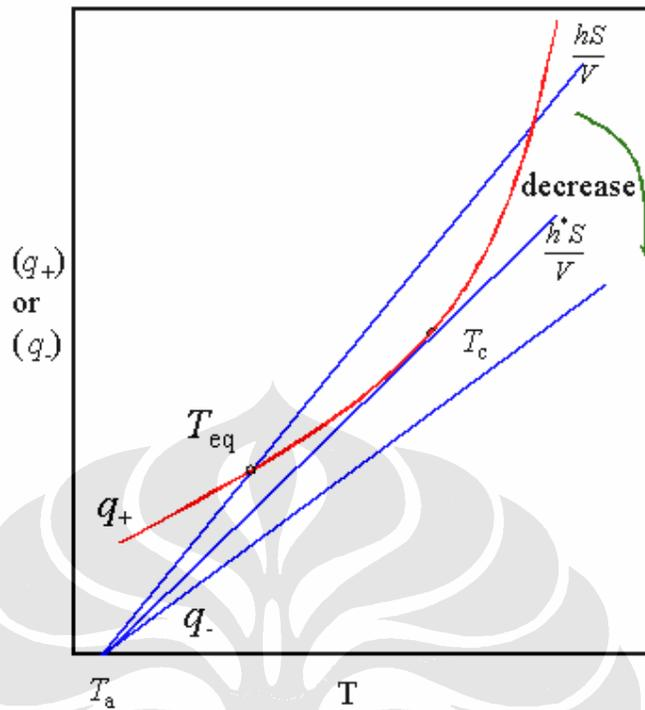
Gambar 2. 18 Plot Pembentukan Kalor Dan Kehilangan Kalor Pada Pemantikan Spontan Campuran Bahan Bakar Dan Oksidan Dalam Bejana Tetap
