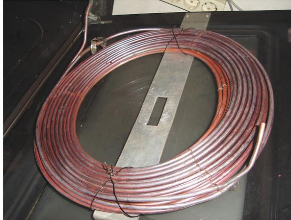
**Gambar 3. 4** Pipa tembaga yang diletakan di dalam oven
