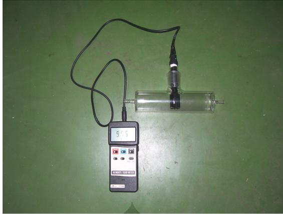
Gambar 3. 13 Humidity meter dan kolom ukur
