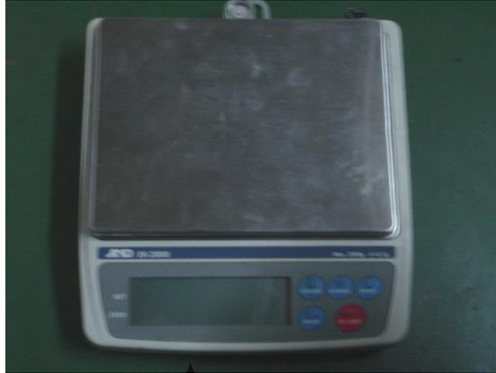
**Gambar 3. 11 Timbangan Elektronik**
