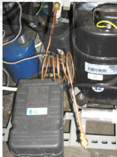
Gambar 4.16 Saluran pipa kapiler pada pentil sistem low-stage
