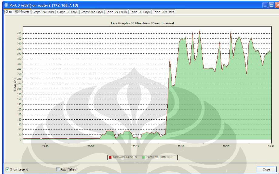
Grafik pembacaan PRTG untuk pemakaian *bandwidth* pada *mesh client E* pada pengujian pertama.
