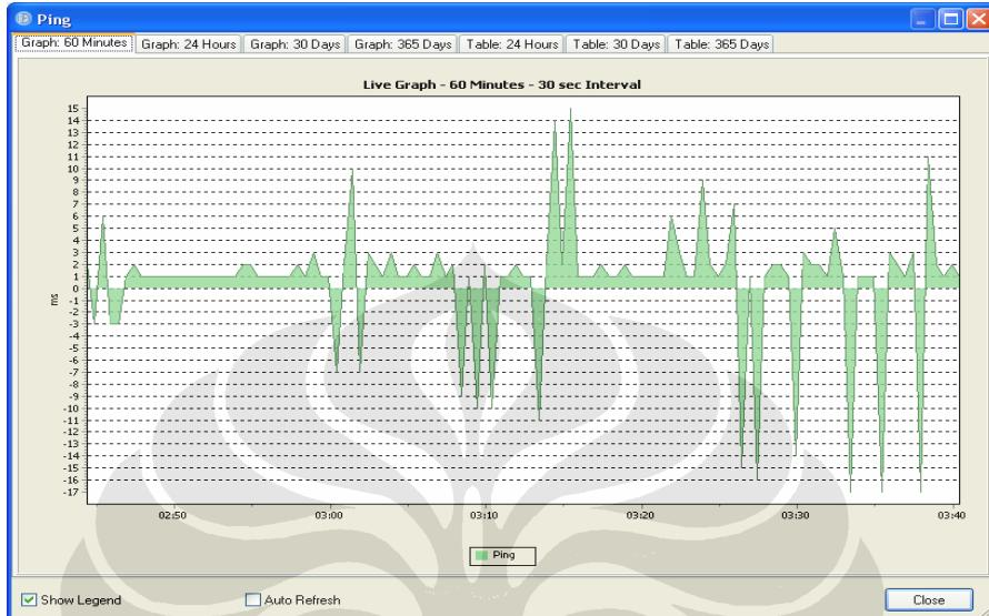
Grafik pembacaan PRTG untuk pengamatan *latency* pada *mesh client E* pada pengujian ketiga.
