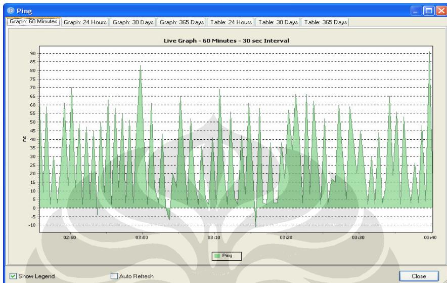
Grafik pembacaan PRTG untuk pengamatan *latency* pada *mesh client B* pada pengujian ketiga.
