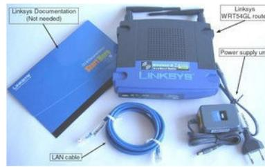
**Gambar 3.3.** *Wireless router linksys WRT54GL versi 1.1 dan perlengkapannya.*
