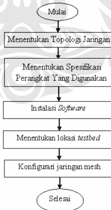
**Gambar 3.1.** Diagram alir tahapan pembangunan *testbed*.
