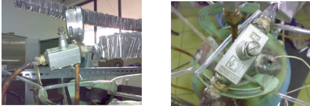
Gambar 3.2 Katup Ekspansi Throttle
