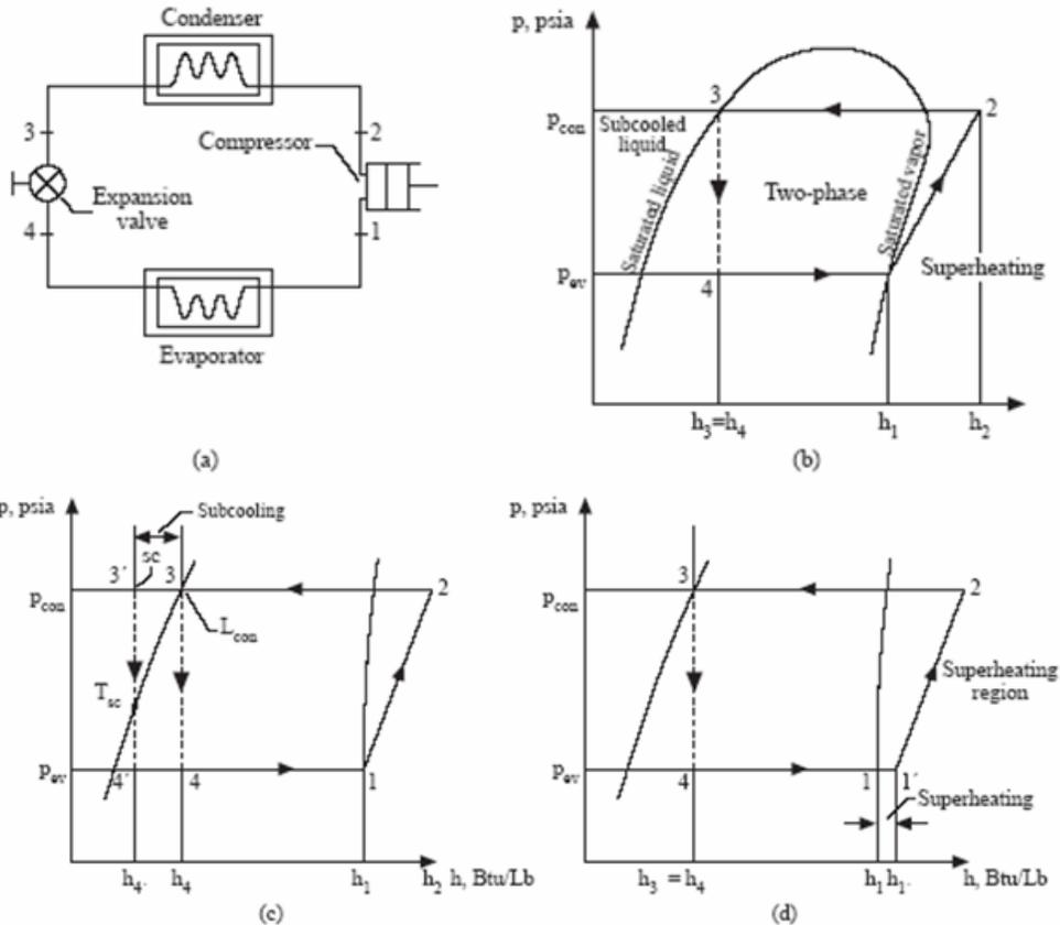
Gambar 3 Siklus refrigerasi kompresi uap satu tingkat ideal: (a) skema diagram, (b) diagram p-h, (c) pendinginan bawah (subcooling), (d) pemanasan lanjut (superheating)
