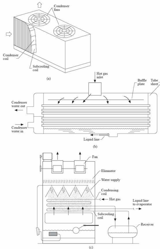
Gambar 4 Berbagai jenis kondenser refrigerasi: (a) Berpendingin udara, (b) berpendingin air, (c) berpendingin evaporatif
