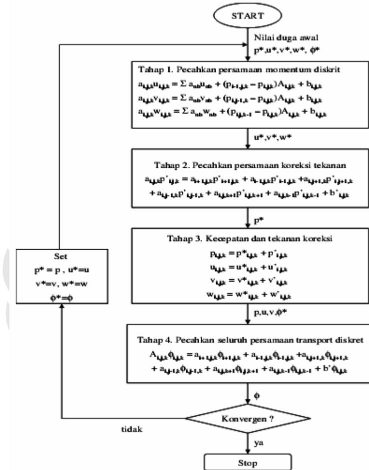
Gambar 8 Algoritma numerik volume hingga dengan metode SIMPLE
