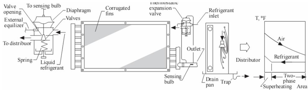
Gambar 5 Direct expansion coil dengan katup ekspansi termostatik
