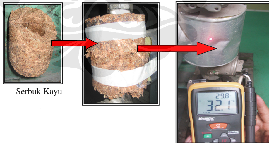
Gambar 4.7 Ilustrasi Pengambilan data temperatur pada pipa condensate uap panas untuk bahan isolator Serbuk Kayu.
