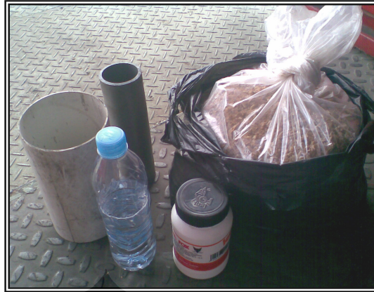
Gambar 4.8 Bahan-bahan yang dibutuhkan untuk membuat isolator berbahan serbuk kayu.
