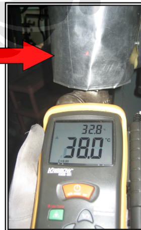
Gambar 4.6 Ilustrasi Pengambilan data temperatur pada pipa condensate uap panas untuk bahan isolator Rockwool .
