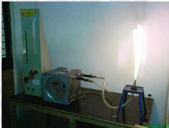
Gambar 3.5 Prosedur Penyesuaian Skala *Rotameter*
