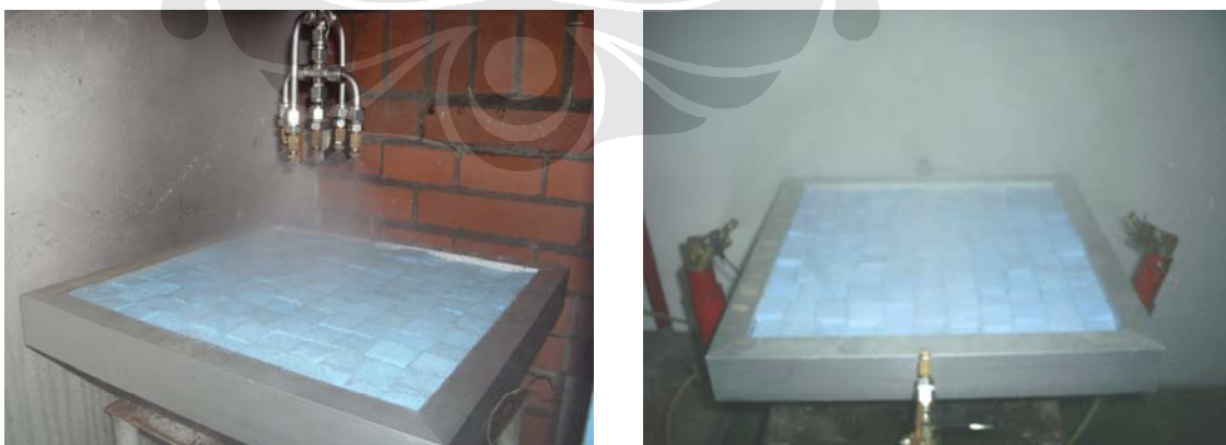
Gambar 4.4 Perbedaan Penyemprotan Dari Atas Dan Dari Sisi Samping Bawah
