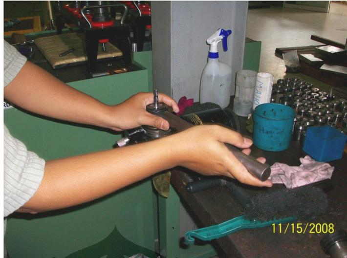
Gambar 3.10. Pemasangan *Tool* pada *Tool Holder*
