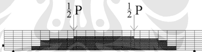
Gambar D.13.4. pola retak saat ultimate pada balok PP2R2-3
