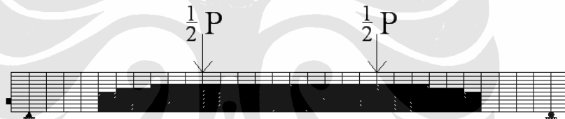
Gambar D.1.4. pola retak saat ultimate pada balok PP2R3-3
