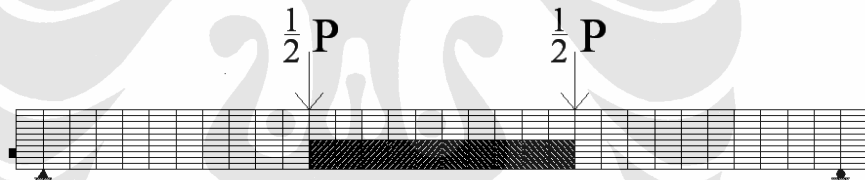
Gambar D.5.4. pola retak saat ultimate pada balok P1R3-3
