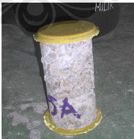
Gambar 4.5.2.2.b. Pemberian Mortar Belerang ( Capping )
