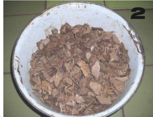
Material granular tempurung kelapa (ukuran \pm 2 cm)
