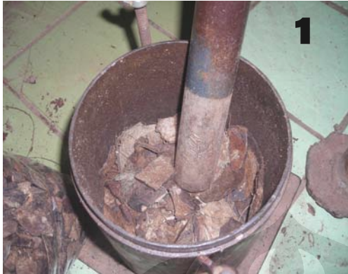
Penghancuran tempurung kelapa menjadi material granular (ukuran \pm 2 cm)
