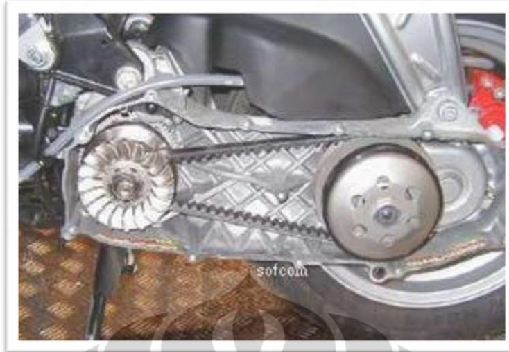
Gb. 2.5 Transmisi CVT pada motor *Kymco* (ref. [www.kymco.com](http://www.kymco.com))
