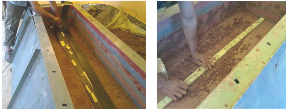
Gambar 5.14. Peletakan Material Uji Pada Pull Out Box
