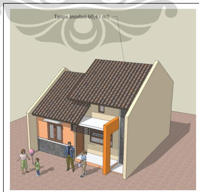
Gambar 4.13 Skematik bangunan studi kasus yang menggunakan genteng keramik tanpa insulasi menunjukkan luas atap sekitar 60,43 m<sup>2</sup> (Sumber: Dokumen penulis menggunakan *software Google Sketchup 6*, 2009)
