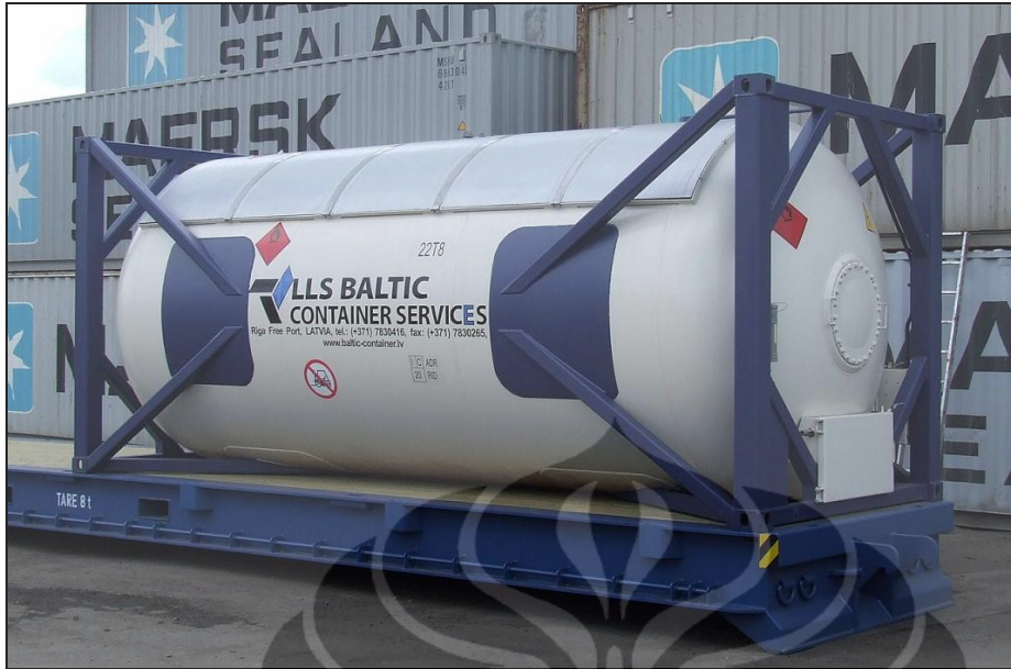
Gambar 2.10a ISO tank/tangki kontainer untuk transportasi LPG dengan kereta api
