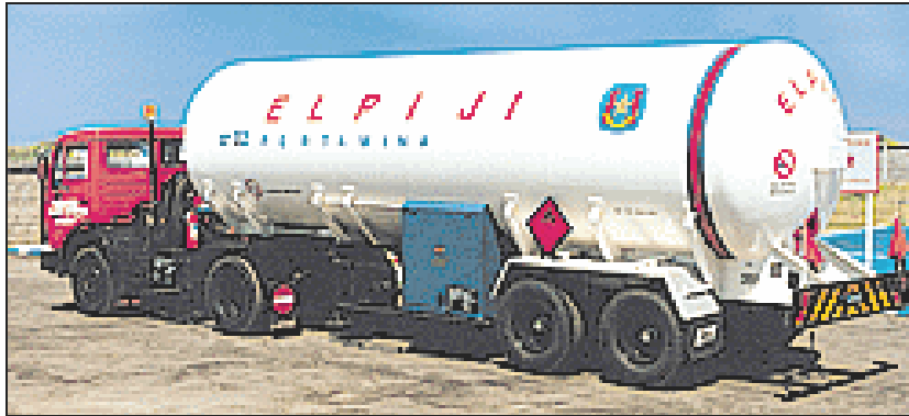
Gambar 2.9b. Truk tangki LPG besar (kapasitas 15 ton)
