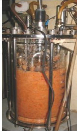
Gambar L7.5. Fermentor Biostat untuk proses demineralisasi dan deproteinasi
