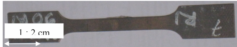
Gambar 3.14. Sampel uji tarik untuk analisa mampu bentuk pelat : elongasi, kuat tarik maksimum, ‘n’ : koefisien pengerasan regang, ‘r’ : anisotropi normal/rasio regangan plastis, dan ‘ \Delta r ’ : anisotropi planar/ earing .
