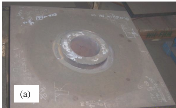
Gambar 3.8 (a) Pengontrolan Laju Pendinginan dengan Udara (b) Pengontrolan Laju Pendinginan dengan Blanket
