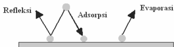
Gambar 2.10 Skema Mekanisme Penyerapan Langmuir pada Plat Rata
