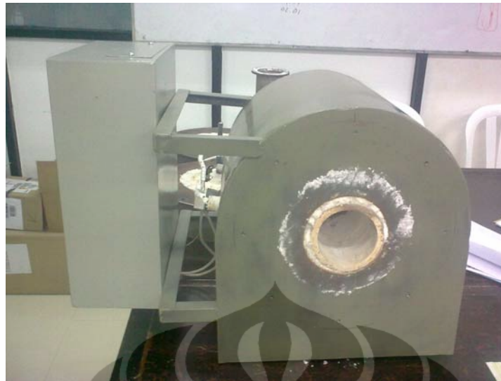
Furnace dengan posisi horizontal
