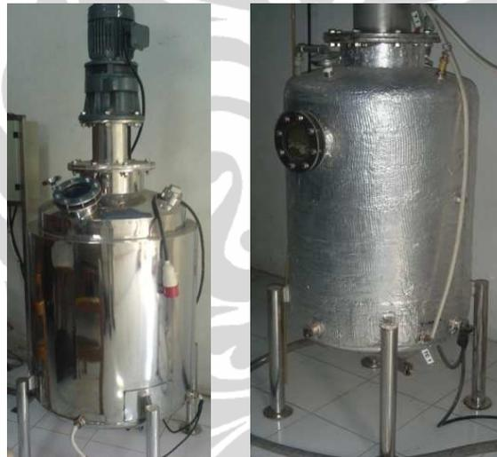
**Gambar 3. 4** Reaktor (a) dan Distilator (b) Bioetanol Berbahan Baku Bagas
