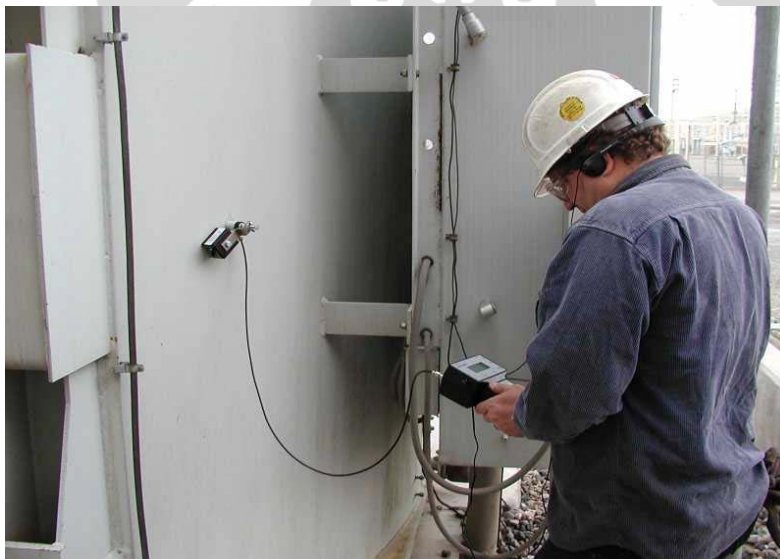
Gambar 2.19: Pengukuran parsial discharge pada saat on-line, dengan AED-2000
