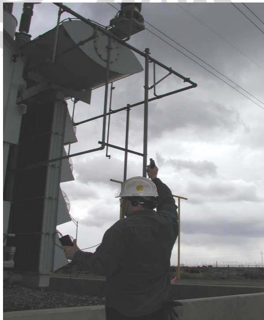
Gambar 2.21.: Pengukuran parsial discharge pada saat on-line, dengan ultrasound instrumen
