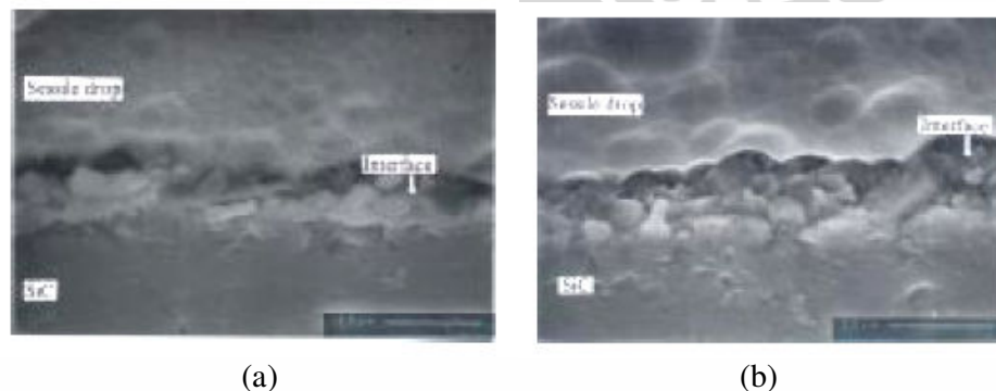
Gambar 2.15. Mikrograf antar muka matrik paduan Al dengan partikel SiC (a) Al murni – SiC (b) paduan Al-13,9Mg dengan partikel SiC [29] .
