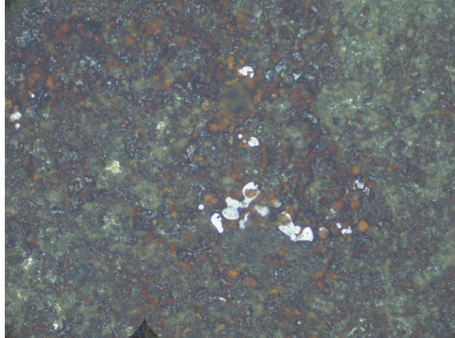
Gambar 5.19 Kupon pada CO 2 1 % dengan laju korosi 0,0003 mm/tahun. Perbesaran 100x.
